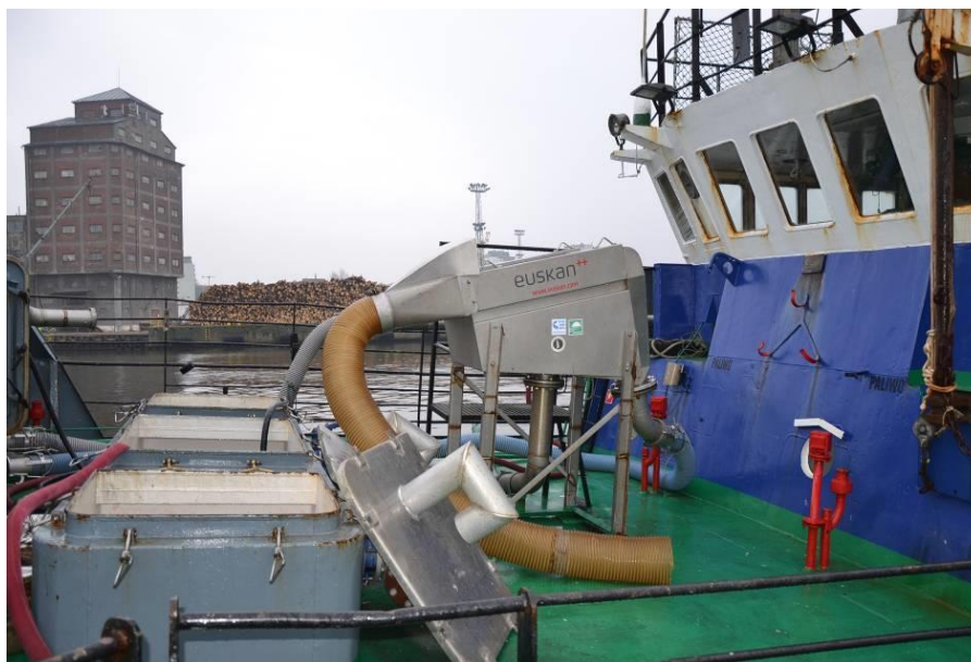
Fot. 1. System pompowy firmy Euskan zainstalowany na kutrze (fot. MIR-PIB)
