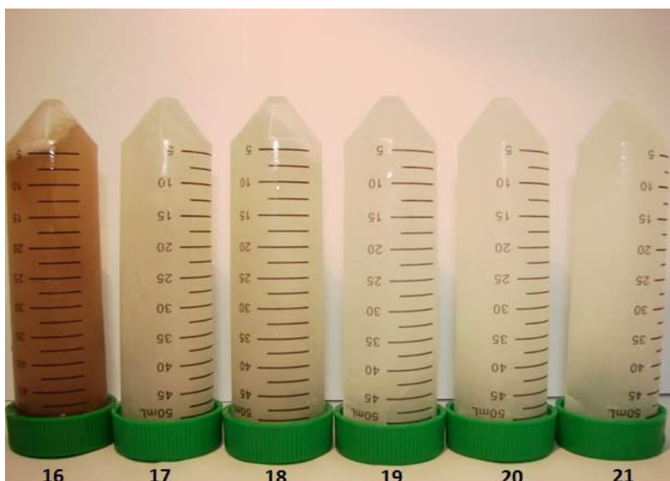
Fot. 28. Próbkki 16-21 surowych, zużytych wód technologicznych
