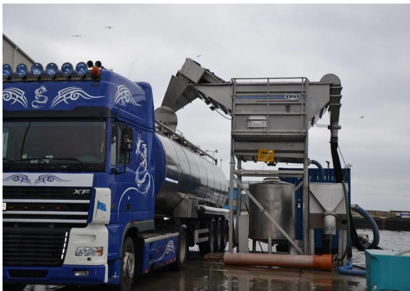
Fot. 3. Wyładunek ryb do cysterny samochodowej za pomocą instalacji firmy IRAS (fot. MIR-PIB)
