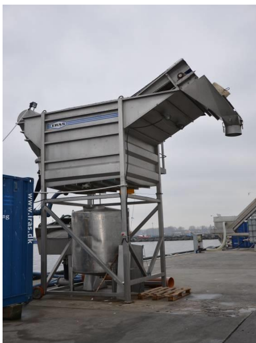
Fot. 12. Instalacja firmy IRAS do hydraulicznego wyładunku ryb (fot. MIR-PIB)
