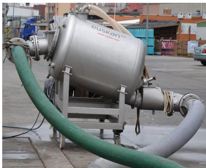
Fot. 13. Instalacja firmy Euskan do hydraulicznego wyładunku ryb (fot. MIR-PIB)
