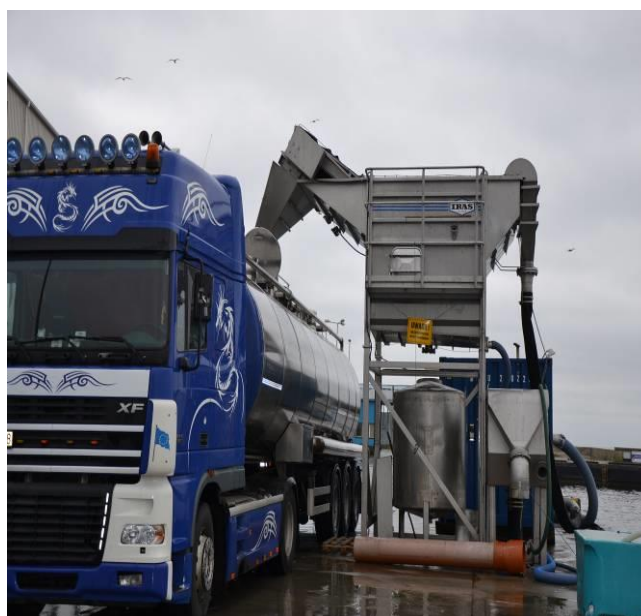
Fot. 10. Załadunek ryb do cysterny samochodowej (fot. MIR-PIB)
