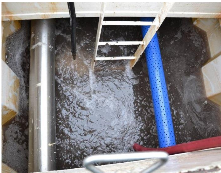
Fot. 16. Zbiornik kutra wypełniony zużytą wodą technologiczną po wyładunku ryb (fot. MIR-PIB)
