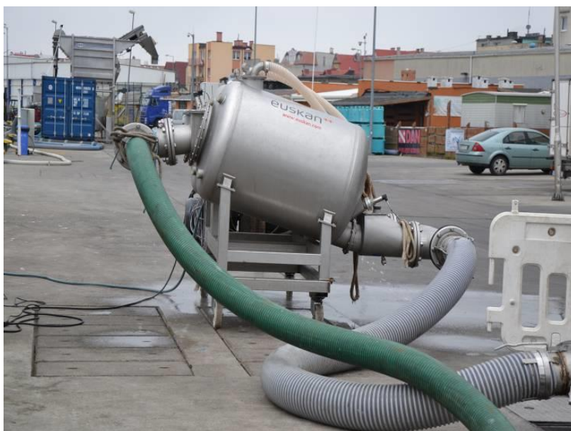
Fot. 2. Instalacja pompowa firmy Euskan do hydraulicznego transportu ryb w porcie (fot. MIR-PIB)
